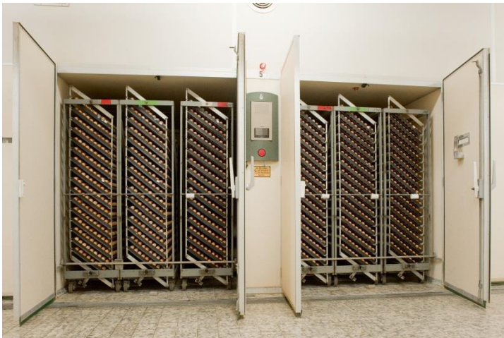
Abbildung 8: Brutschrank in einer Brüterei. Quelle: Niedersächsische Geflügelwirtschaft.
