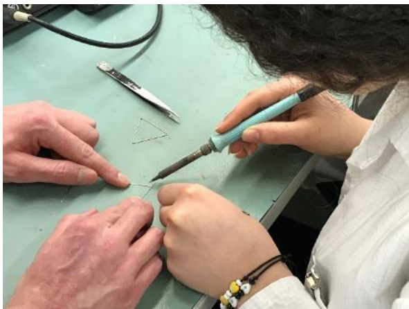
Foto II (Universität Vechta/Tiller) Die Schüler*innen verlöten in der Lehrwerkstatt der Azubis kleine Drähte zu einer Pyramide.
